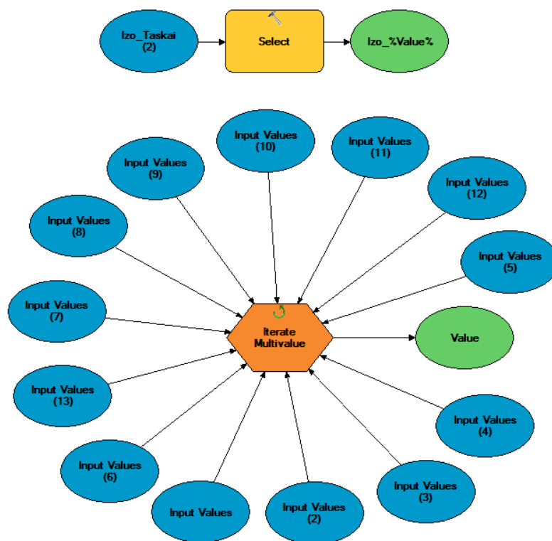
2.7.5 pav. Geoduomenų apdorojimo modelio „Atskirti laikotarpius“ grafinis vaizdas. Rusvas rombas atvaizduoja iteratorių. Iteratorius vykdo modelį duotą skaičių kartų su kiekvienu įvesčių parametru (šiuo atveju - laikotarpiu).
