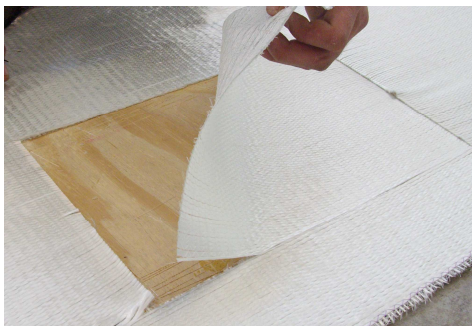
4.3.1. pav. Bandymo metu atkirstas stiklo audinio ruošinys.
