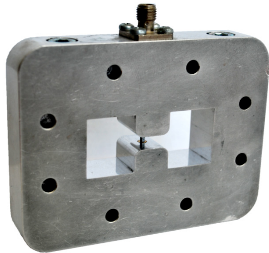
36 pav. Tiriamojo jutiklio sumontuoto pagamintoje WRD250 bangolaidžio sekcijoje vaizdas
