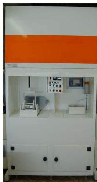
3.1.17 pav. Sukurtas ir įdiegtas gamyboje patobulintos konstrukcijos ėsdinimo įrenginys.
