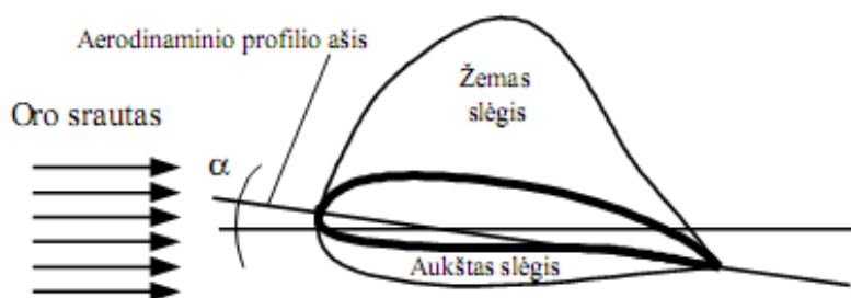
4.4 pav. Skirtingo slėgio zonos aerodinamiame profilyje [8]
