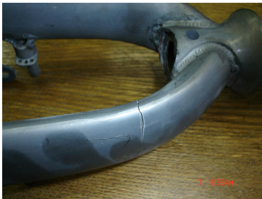
3.13 pav. Technologinių bandymų centre bandymų metu lūžusi šakė
