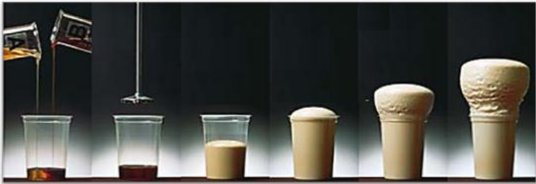
3.16 pav. PU-PIR putplasčio susidarymas, sumaišius A ir B komponentus
