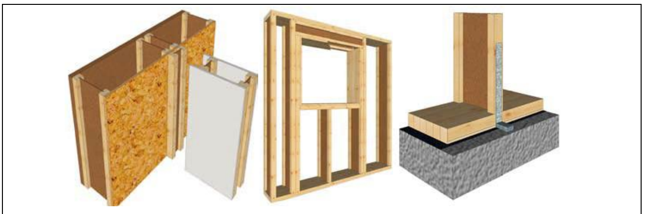
10 pav. STEICO wall sienų konstrukcija [13]
