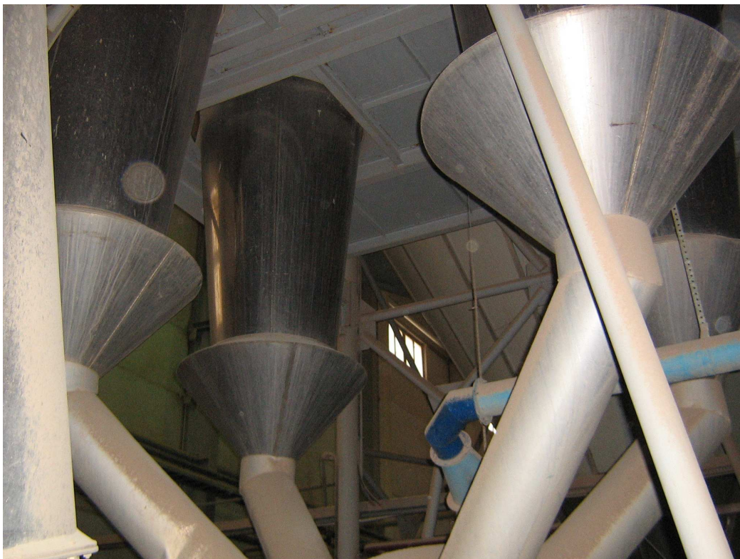
12 pav. Oro valymo įrenginiai sudaryti iš keturių ciklonų
