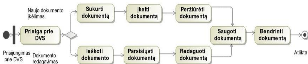
14 pav. Dokumentų talpinimo ir koregavimo panaudos atvejų diagrama
