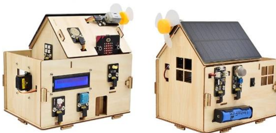
3.2. pav. Išmaniųjų namų automatizavimo sistema naudoja Micro:bit mikrokompiuterį.
