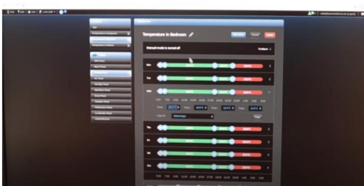
1.9. pav. „FIBARO“ temperatūros scenarijaus modelis.
