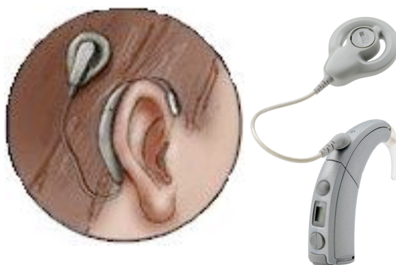
2 pav. (Cochlear Hybrid) Ritė, ritės laidas, kalbos procesorius/ elementų konteineris ir mikrofonas
