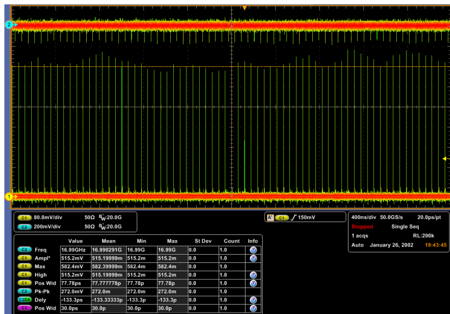
6.15 pav. Generuojami impulsai (apačioje) naudojant 17,02437 MHz moduliavimo dažnį. Viršuje matomas modulatoriaus valdymo signalas.
