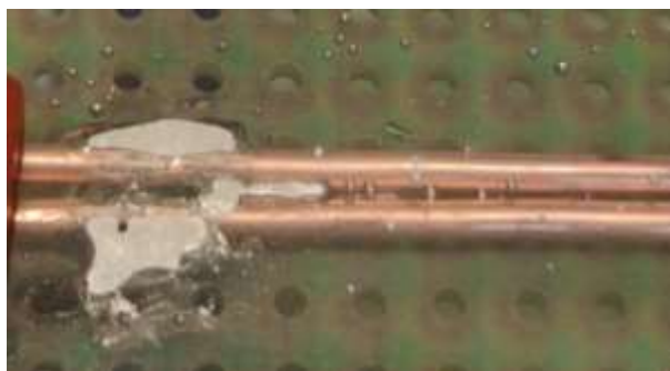
37 pav. Tiesinis kapiliarinis variklis su apvalaus skerspjūvio vario laidais
