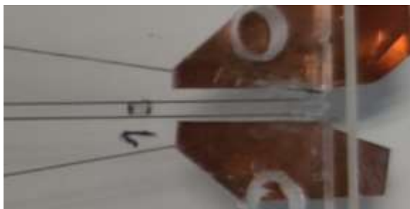
31 pav. Tiesinis kapiliarinis variklis iš nerūdijančio plieno stygų
