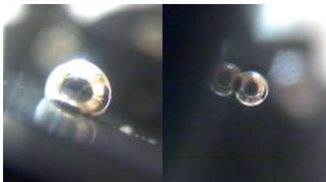
25 pav. Kairėje – 2,3 mm skersmens lašas gulintis ant 28° pakrypusios geležies plokštelės; dešinėje – 1,1 mm skersmens lašas kabantis ant 116° pakrypusios geležies plokštelės
