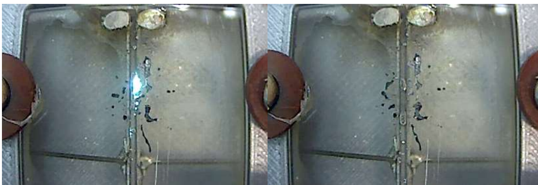
43 pav. Gyvsidabrio lašas po daugybinių kibirkščių suskilęs į kelis lašelius, o dalis gyvsidabrio sprogo metu palindusi tarp epoksidinės dervos ir stikliuko
