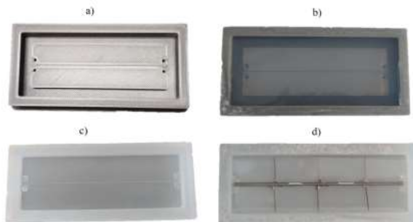
39 pav. Bandymų stendo gamybos etapai. a – 3D spausdintuvu atspausdinta forma, b – įlietas silikonas, c – silikoninė forma, d – į silikoninę formą įstatyti bėgiai ir įlieta skaidri epoksidinė derva
