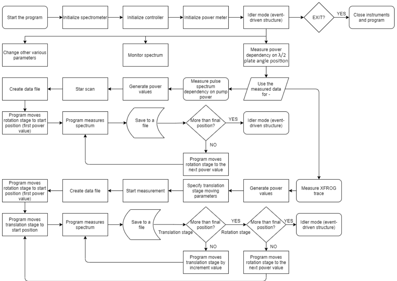
24 pav. Blokinė LabVIEW diagrama, skirta pademonstruoti duomenų sklaidimo seką, kuri naudojama XFROG pėdsako priklausomybės nuo kaupinimo galios matavimo metu. Matavimo programa taip pat buvo naudojama ir bakalauro baigiamajame darbe [66].
