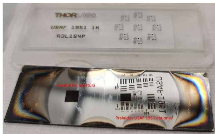
16 pav. Thor Labs bei abluotas USAF 1951 taikynys ir kvadratinė apertūra. Pastaba: etalono modelis sumažintas 4 kartus nekeičiant žymėjimo, dėl to realūs grupių numeriai 2 indeksais didesni.
