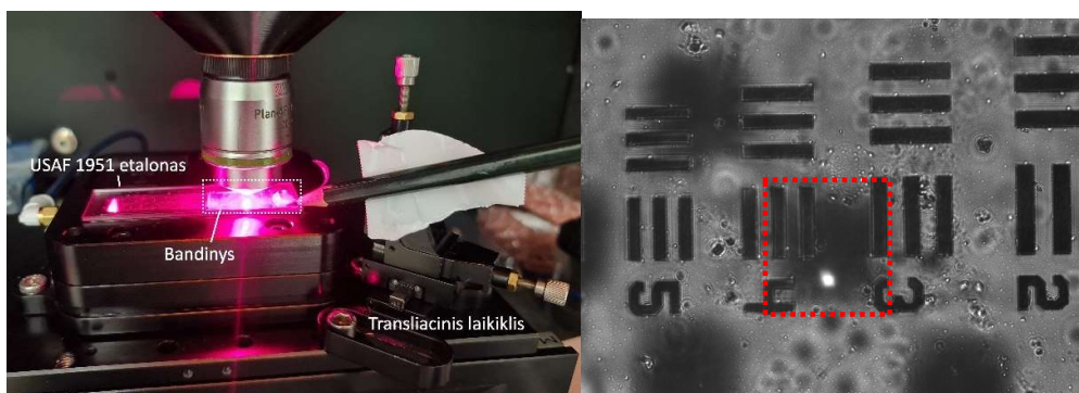
19 pav. Raiškos matavimas staklėse. Viršuje: matavimo schema; apačioje: taikinio elemento ir mikrodarinių (pažymėta raudonai) dydžio palyginimas.
