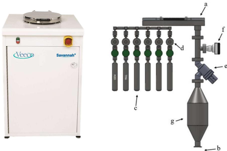
22 pav. Veeco Savannah S200 ALD sistemos schema: a – reaktorius; b – išėjimas į vakuuminį siurblij; c – pirtakų cilindrai; d – pirtakų impulsų sklendės; e – siurbimo sklendė; f – vakuumo daviklis; g – didelio paviršiaus ploto dujų gaudyklė.
