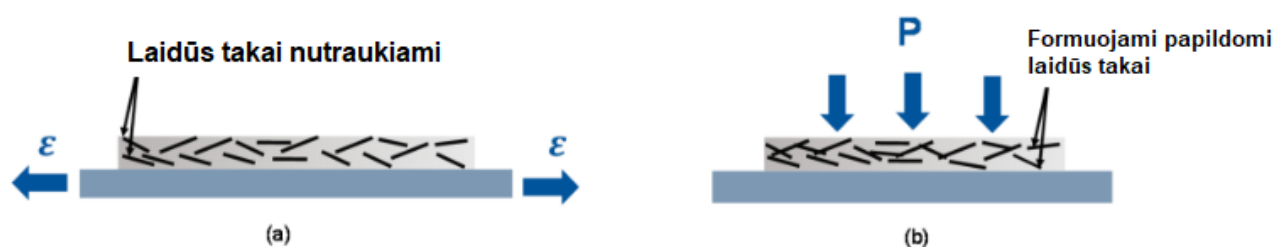
2.2a-b pav. Deformacijos poveikis perkoliacijos tinklui (a) tempimo ir (b) spaudimo atvejais [62].
