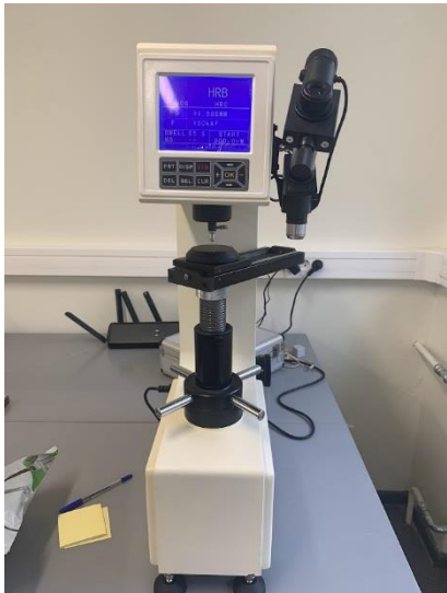
15 pav. Kietumo matuoklis „THBRV–187.5D“ (kairėje) ir jo principinė veikimo schema (dešinėje)
