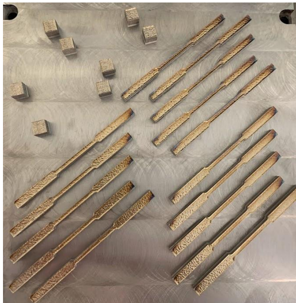
16 pav. Tyrimo metu 17-4 PH medžiagos spausdintų mėginių nuotrauka
