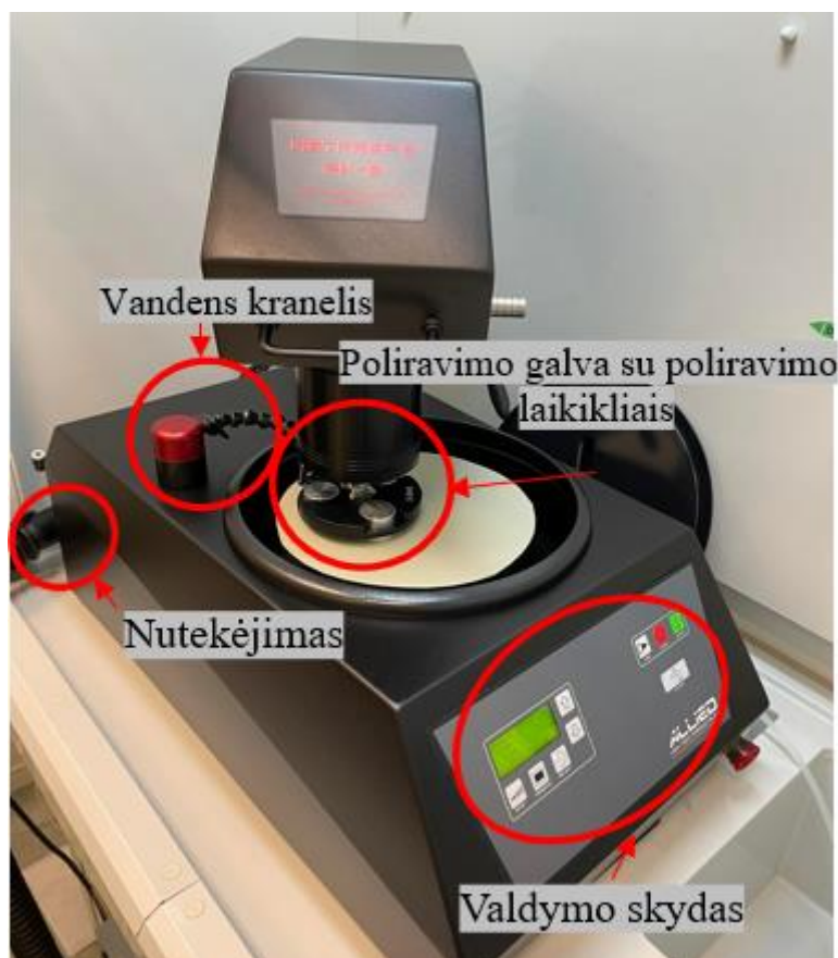
24 pav. Poliravimo mašina „MetPrep 3 Allied High Tech Products“. Ją sudaro valdymo skydas, poliravimo galva su trimis poliravimo laikikliais, vandens kraneliu ir nutekėjimu
