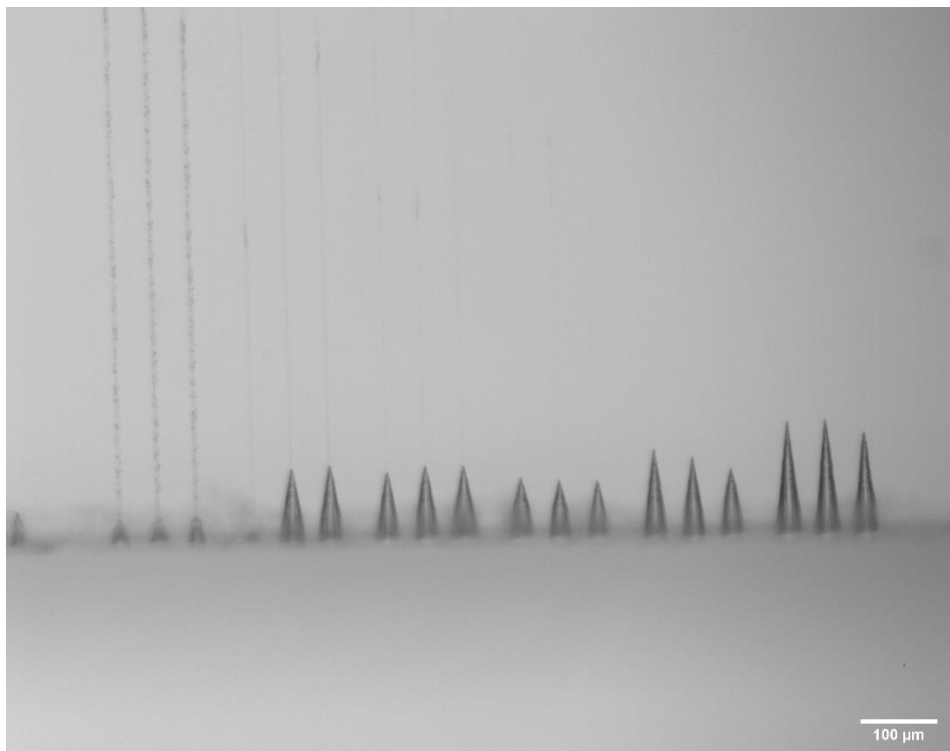
6 pav. Kanalai po ėsdinimo, kai naudojami 400 – 1200 fs trukmės, 2 – 4,5 μJ energijos impulsai ir bandinys transliuojamas 1 – 6 mm/s greičiu.
