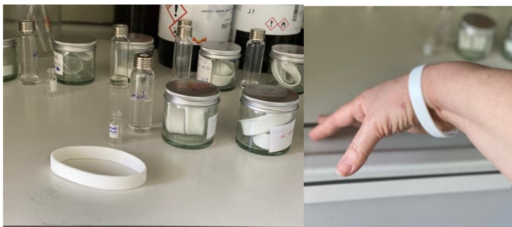
1 pav. silikoninės absorbuojančios apyrankės, kairėje - ruošiamos ekstrahavimui, dešinėje – tyrimo metu ant rankos
