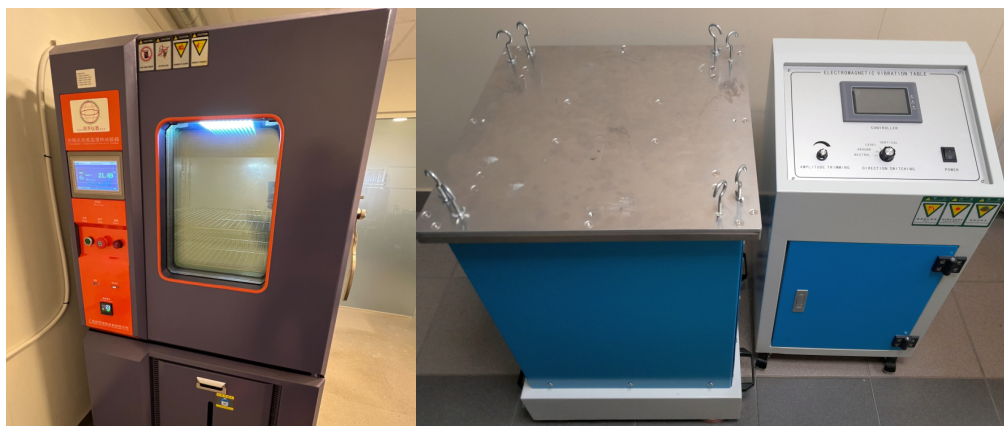
Pav. 9. Termociklavimo kamera (kairėje) ir vibravimo stendas (dešinėje) skirti pagreintiems senėjimo testams atlikti
