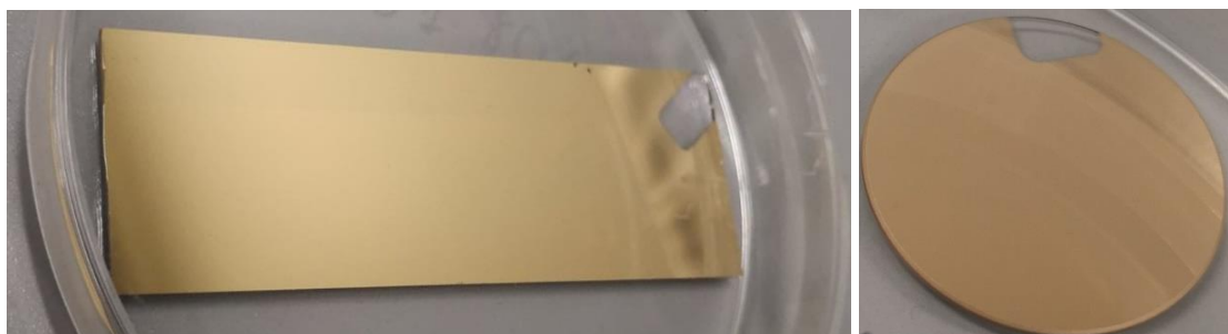
15 pav. Aukso sluoksniu padengtos stiklo plokštelė. EIS tyrimams kairėje, SPR tyrimams – dešinėje.
