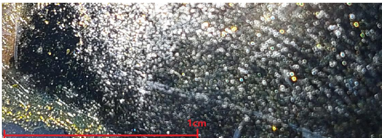
3.1.5 pav. V1205 organinio puslaidininkio sluoksnis (atkaitinus 200°C temperatūroje 30 minučių).
