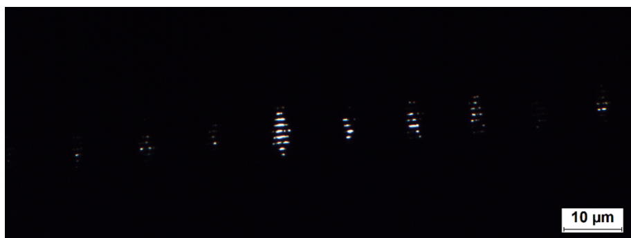
27 pav. Bandinio paviršiuje suformuotos struktūros nuotrauka optiniu mikroskopu, kai PPS_y < 1 . Matavimų metu naudotas apšvietimas iš bandinio galo.
