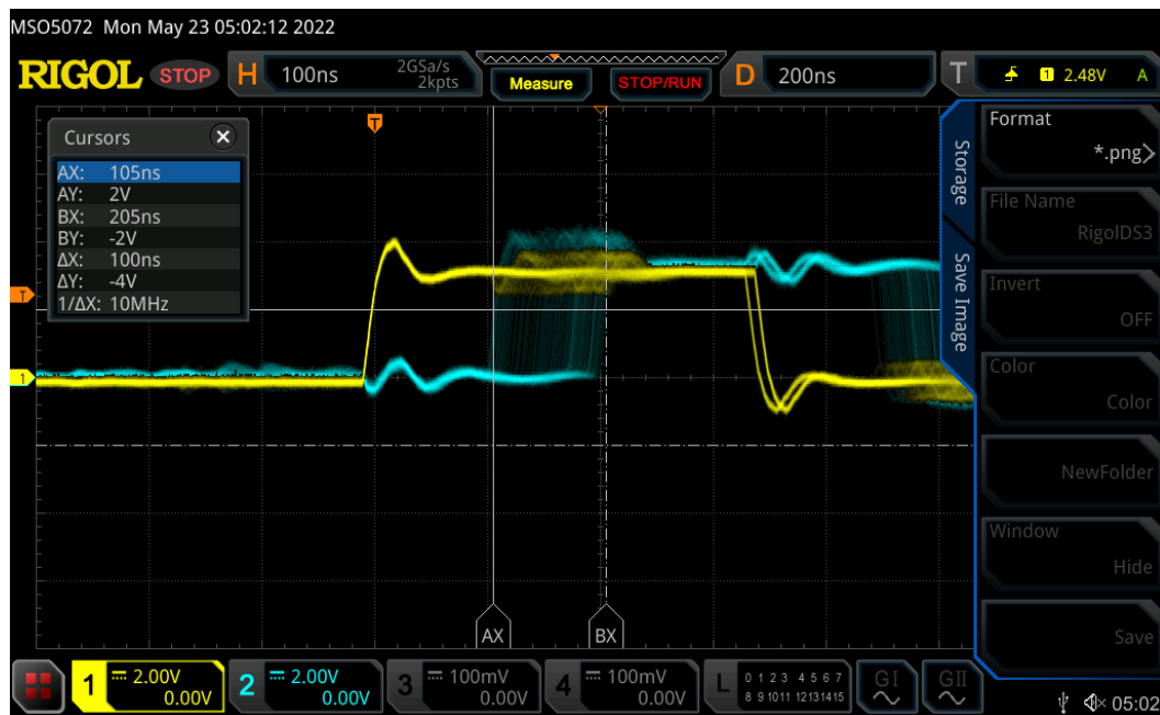
29 pav. Greitaveikos testo oscilografo rodmenys registruojant duomenų priėmimo ir išdavimo sinchronizavimo impulsus. Geltona kreivė – duomenų priėmimo impulsas, mėlyna kreivė – duomenų išdavimo impulsas.
