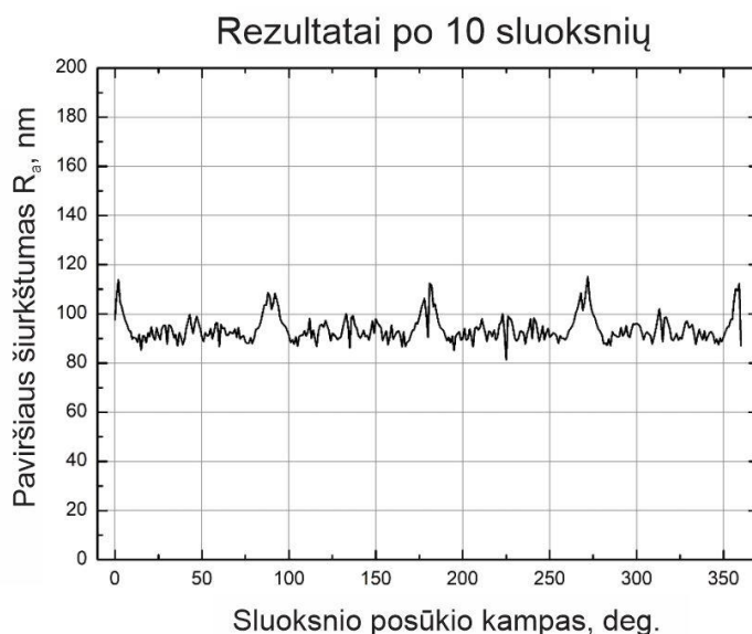
26 pav. Paviršiaus šiurkštumo priklausomybė nuo sluoksnio posūkio kampo po 10 sluoksnių apdirbimo. Rezultatai pasiekti naudojant teorinį modelį. Sluoksnio pozicijos neapibrėžtumas b = 2.1 \mu\text{m} . Šiurkštumas x (skenavimo kryptimi). Sistema sinchronizuota. Lazerinis šaltinis – 3
