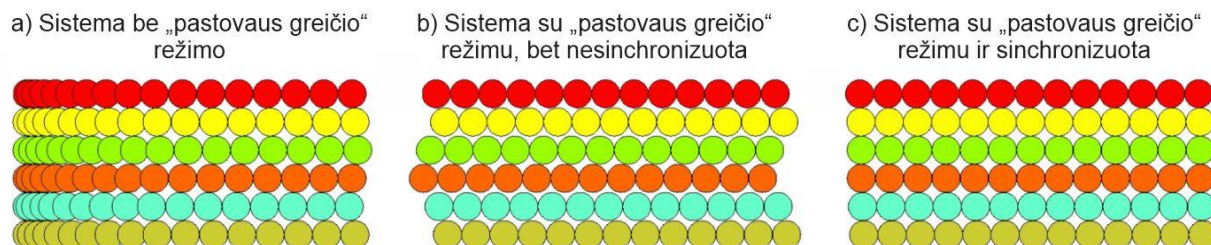
6 pav. Impulsų išdėliojimas naudojant skirtingas skenavimo sistemas. (a) sistema be „sky writing“ režimo, (b) sistema su „sky-writing“ režimu, bet nesinchronizuota, (c) sistema su „sky-writing“ režimu ir sinchronizuota [34]
