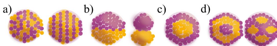
1.5 pav. Bimetalinių nanodalelių rūšys. a) mišrios bimetalinės nanodalelės; b) atskirų pogrupių atskirtos bimetalinės nanodalelės; c) Šerdies–apvalkalo struktūros bimetalinės nanodalelės d) Kelių šerdžių ir apvalkalų struktūros bimetalinės nanodalelės.
