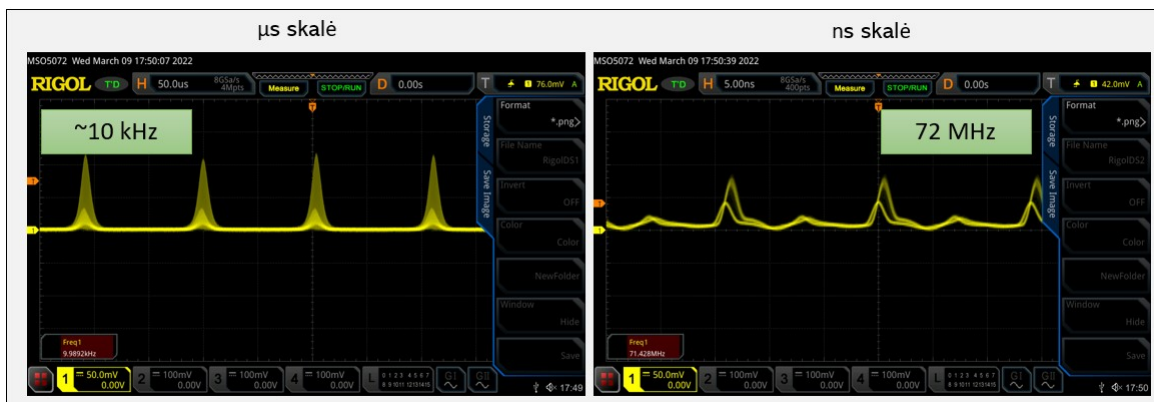
37 pav. D rezonatoriaus (II veikos zona) išvadinės spinduliuotės laikinės charakteristikos fiksuotos osciloskopu
