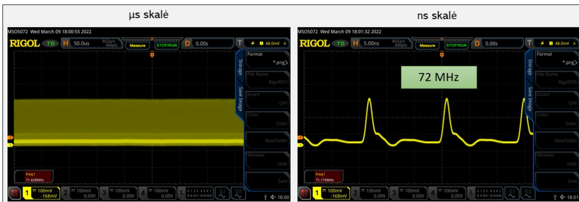
38 pav. D rezonatoriaus (III veikos zona) išvadinės spinduliuotės laikinės charakteristikos fiksuotos osciloskopu
