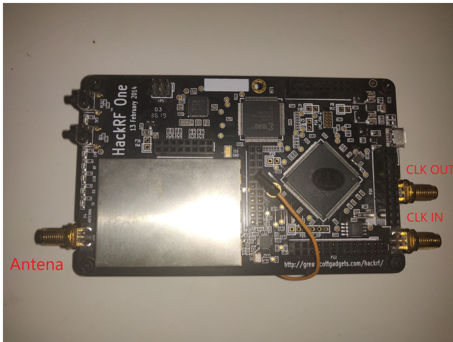
7 pav. HackRF One nuotrauka su pažymėtais įėjimais ir išėjimais.
