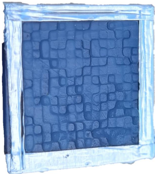
17 pav. 3D spausdintuvu paruoštas difrakcinio neuroninio tinklo paslėptasis sluoksnis
