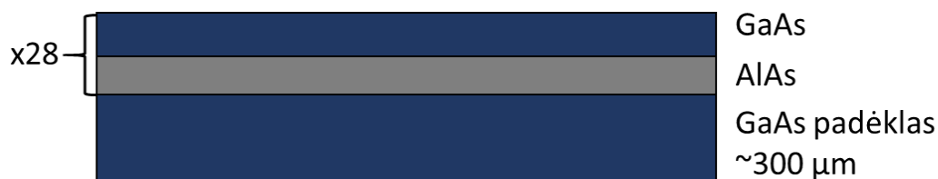
24 pav. Brego veidrodžio su 28 AlAs/GaAs periodais struktūrinė schema.
