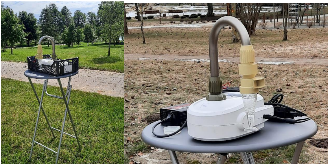
4 pav. Mėginių surinkimo įrenginiai lauko sąlygomis: kairėje 120 cm aukščio stalis su mėginių surinkimo įranga, dešinėje cikloninė oro gaudyklė „Coriolis μ“
