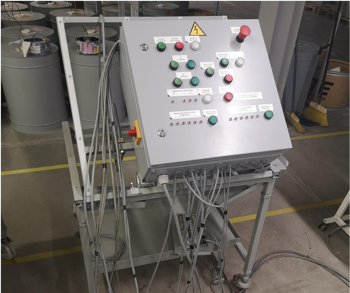
12 pav. „Novatys“ automatikų patikros stendas
