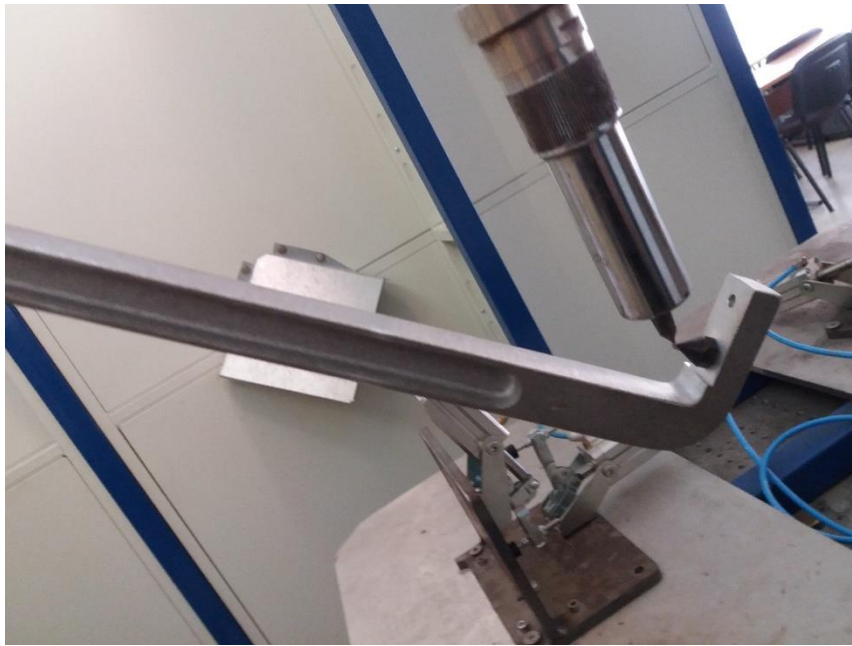
37 pav. Patikrinta ar robotas gerai sukalibruotas
