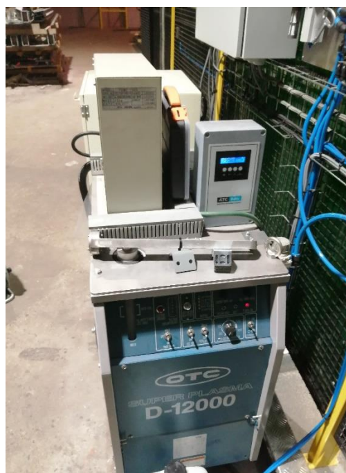
35 psv. Sukurto prietaiso bendras vaizdas (dešinėje); plazminio metalo pjovimo sistema (kairėje)
