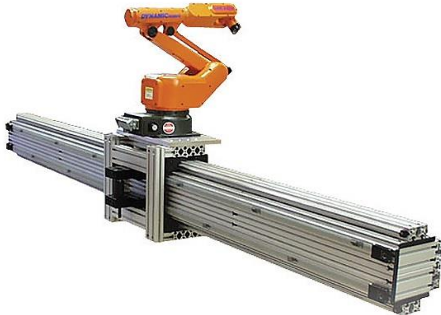
3 pav. Macron Dynamics linijinė judėjimo sistema
