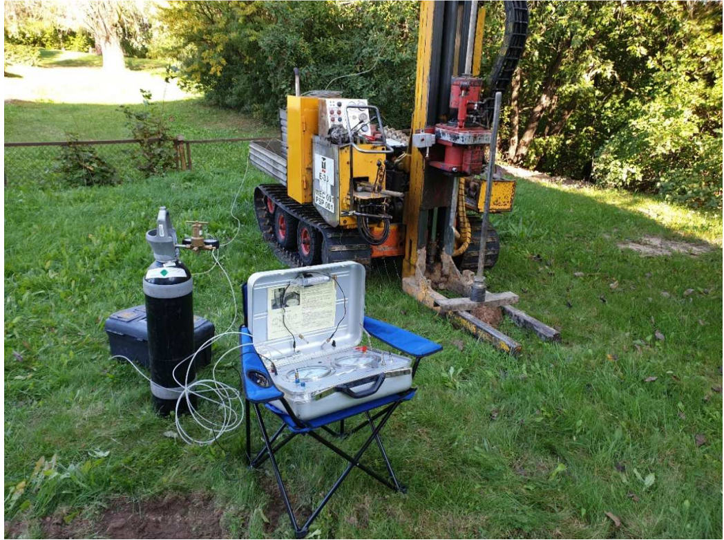
4.2 pav. Tyrimų vietovėje atliekamas dilatometrinių bandymų, 2019 metai, 09 mėn. (autorius nuotr.).
