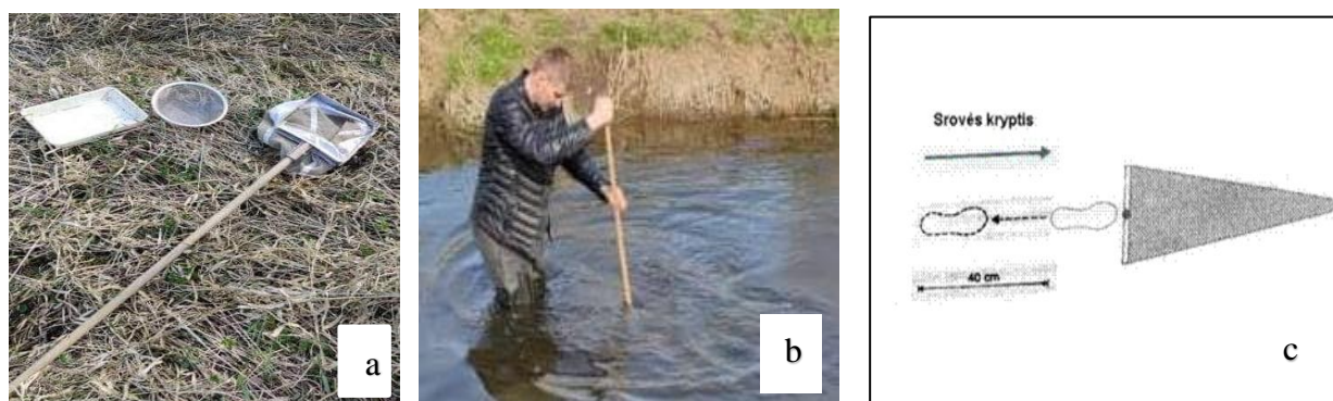
16 pav. a - Mėginio ėmimo įrankiai b - Mėginio ėmimas c- Makrozoobentosos kokybinių mėginių ėmimas „spyrio“ metodu, (LAND 57-2003)
