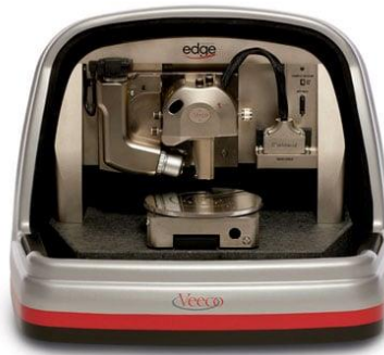
25 pav. Veeco Dimension Edge atominių jėgų mikroskopas.
