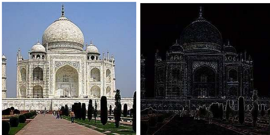
20 pav. Vaizdo filtravimas: originalus vaizdas ir po kraštų aptikimo filtravimo
