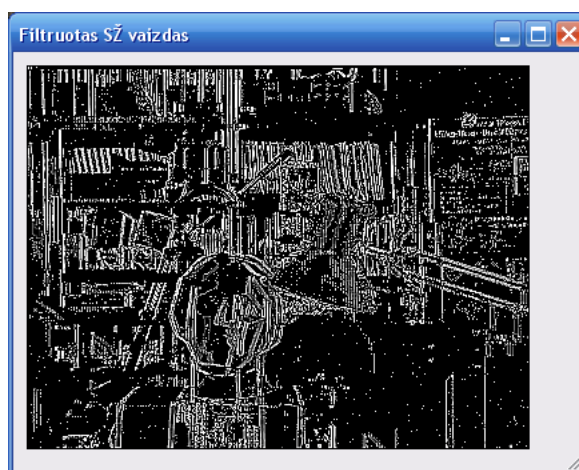
27 pav. Atfiltruotas SŽ vaizdas su objektu kraštų išskyrimu
