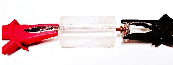
10 pav. Varžos matavimui sukonstruota celė
