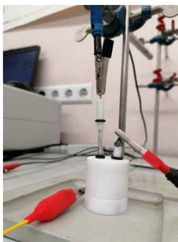
2 pav. Elektrocheminių matavimų sistema.
