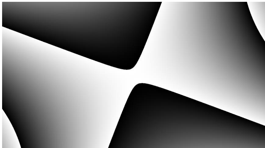
10 pav. Eksperimentų metu naudota fazės korekcijos kaukė. Juoda spalva atitinka nulinių fazinių vėlinimą, kuris tiesiškai didėja iki baltos spalvos arba 2\pi fazinio vėlinimo.
