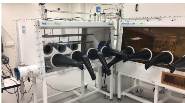
7 pav. Fotonikos ir nanotechnologijų instituto Organinės optoelektronikos grupės laboratorijoje (ISO7 klasės švarios patalpos) esančios kameros su azoto atmosfera.
