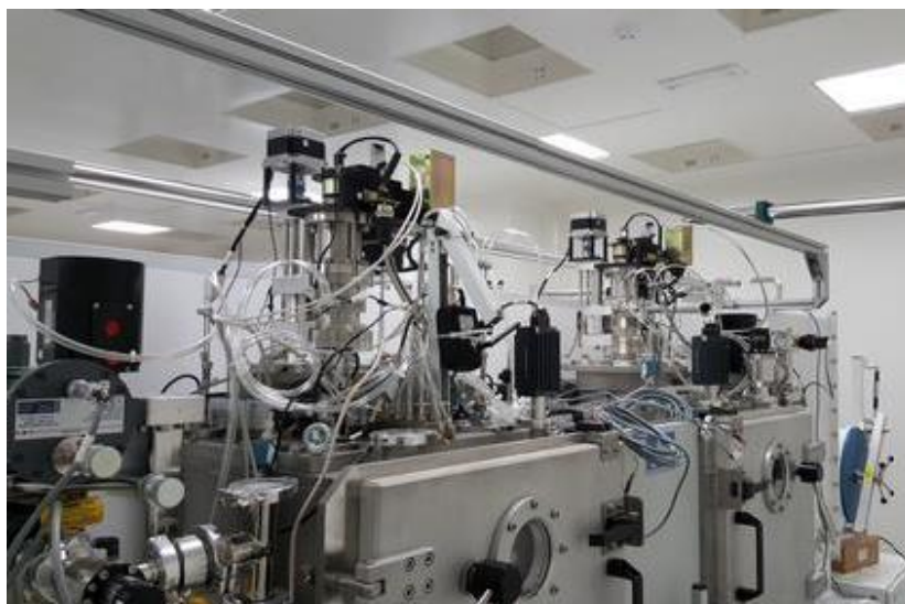
2.6. pav. Vakuuminio garinimo įranga VU FNI (kairėje) ir OLED padėklas (dešinėje).
