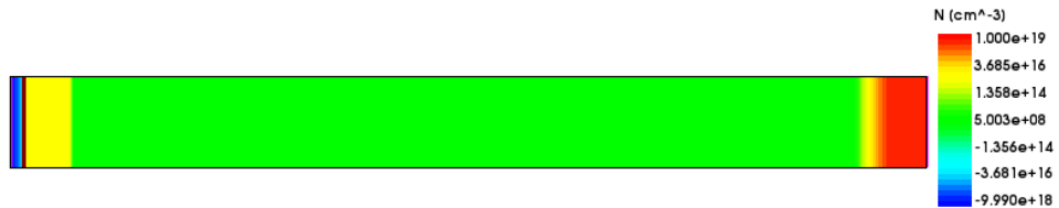
3.1 pav. Modeliuojamo n-tipo LGAD struktūra xy-plokštumoje.
