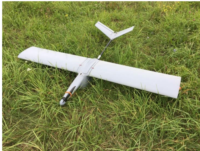
23 pav. Fiksuotų sparnų bepilotis orlaivis „Suopis“ [29]
