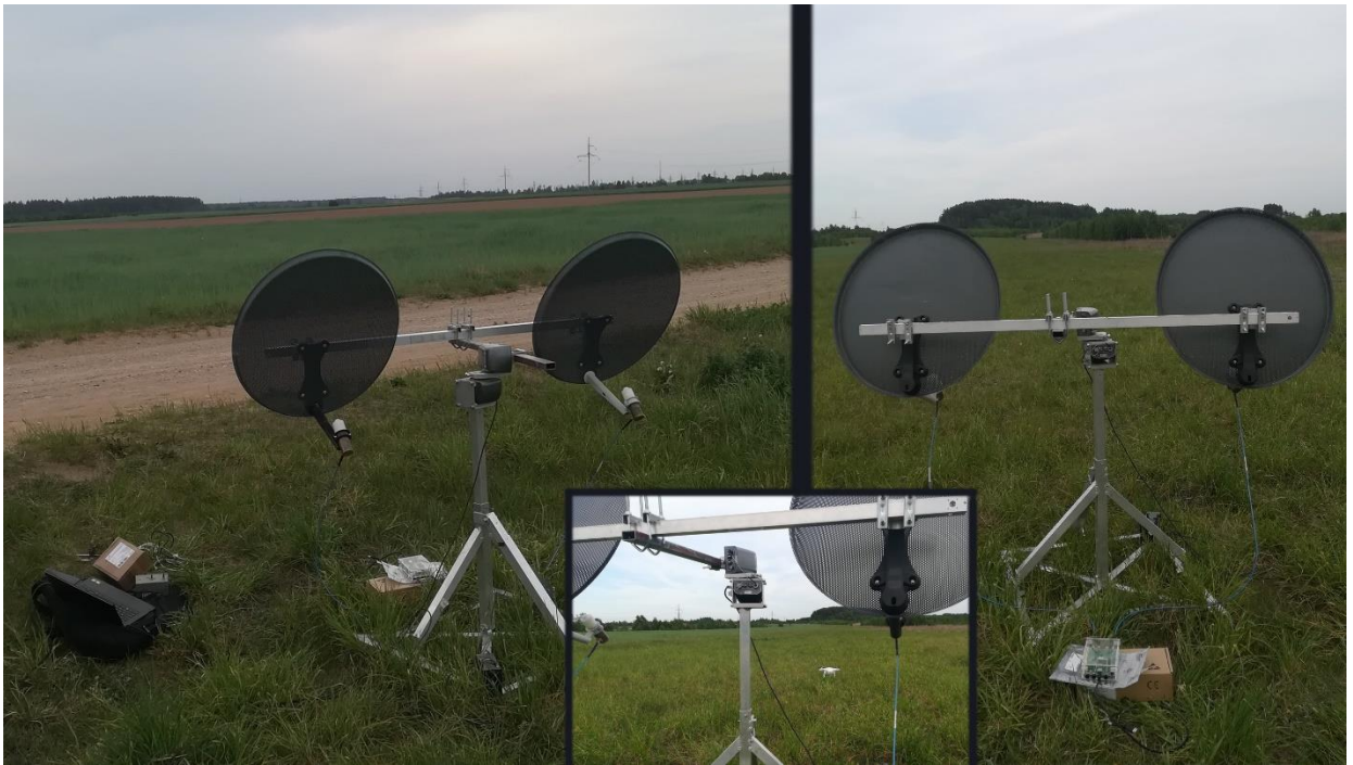
9 pav. USRP FMCW radaras su prijungtomis kryptinėmis antenomis: viena siųstuvui, kita imtuvui Bandymų metu naudotų spindulių su paraboliniiais reflektoriais (žr. 9 pav.) stiprinimas nustatomas pagal [30]
