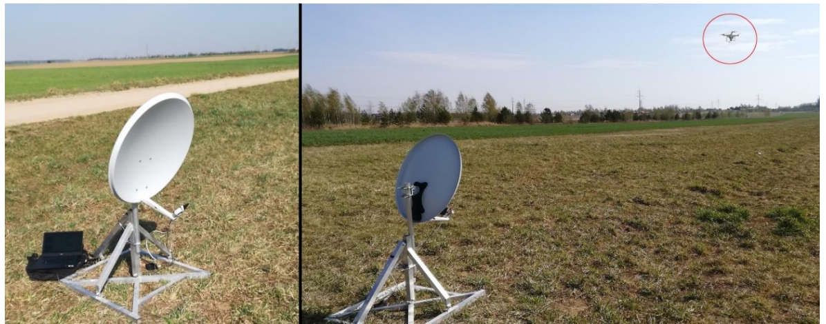
14 pav. AWR1642Boost radaro plokštės ir parabolinio reflektoriaus sistema, matavimo erdvė ir DJI Phantom 3 BPO
