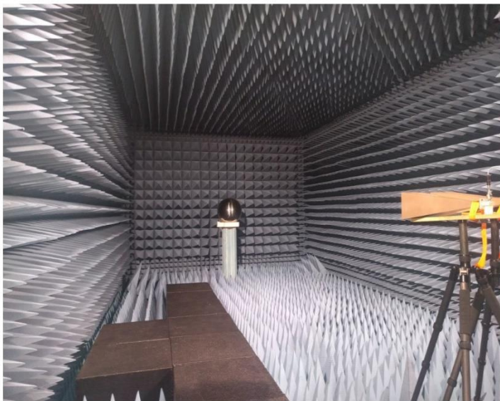
5 pav. Kalibravimas su sfera: a – centimetrinių bangų diapazone su 50 cm skersmens sfera, 6.05 m. atstumu nuo antenų, b – milimetrinių bangų diapazone su 28 cm skersmens sfera 2.70 m. atstumu nuo milimetrinių bangų radaro plokštės
