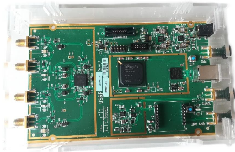
6 pav. Ettus USRP B210 programinio radijo plokštė
