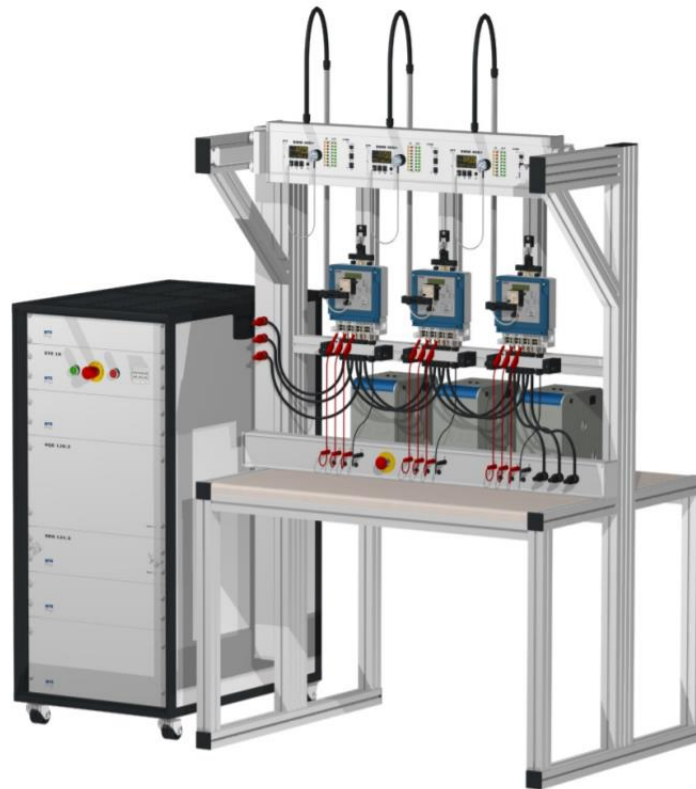
25 pav. Stacionarus elektros energijos skaitiklių testavimo stendas [10]
