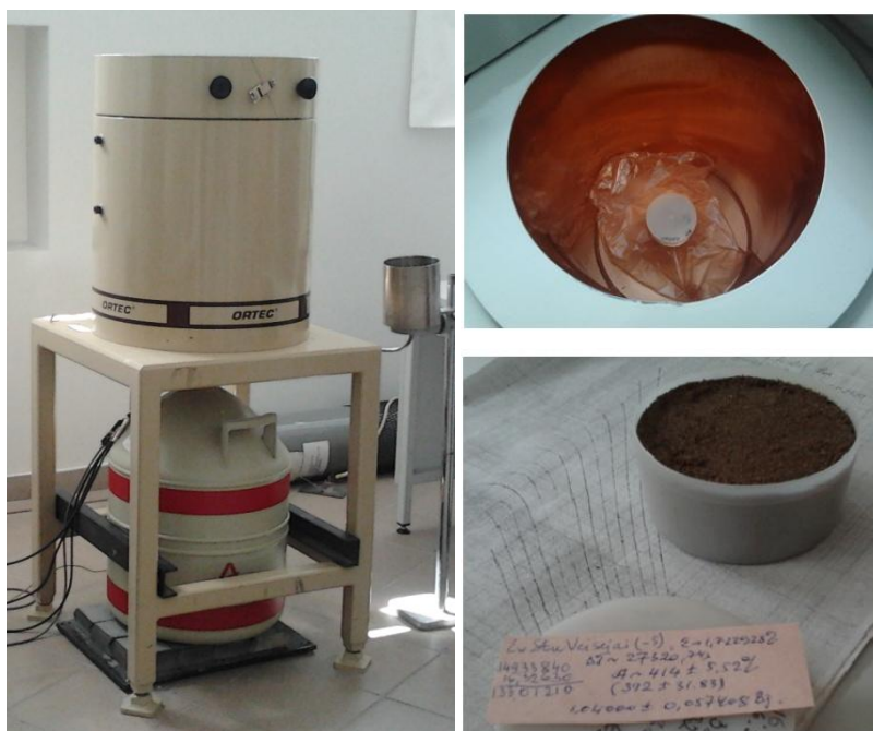
12 pav. Puslaidininkinis gama spektrometras (kairėje), bandinys pastatytas ant detektoriaus (dešinėje viršuje), bandinys paruoštas matavimams (dešinėje apačioje).
