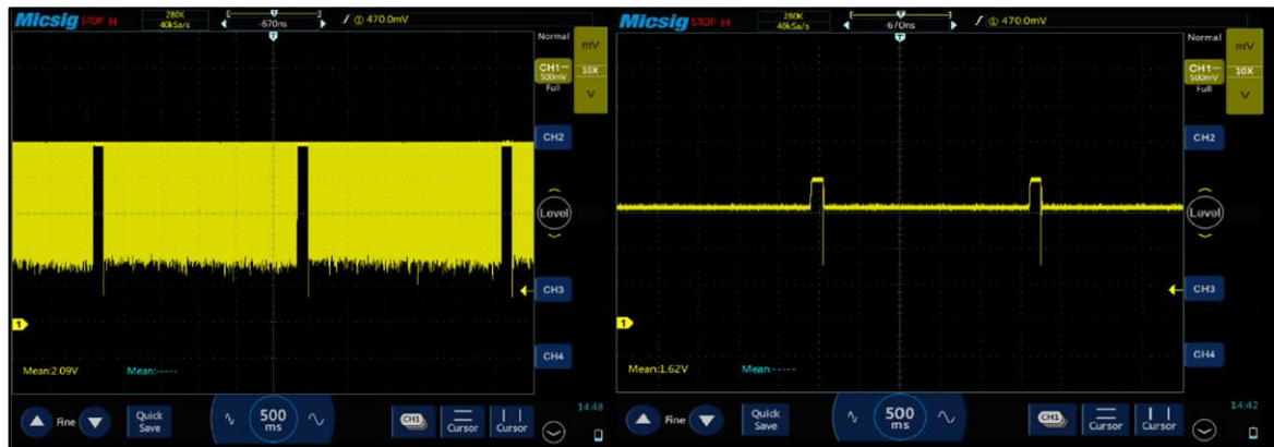
37 pav. CY39C831 įtampos pulsacijos be papildomo kondensatoriaus įėjime ir įtampa su papildomu kondensatoriumi esant 2.5V EVJ ir 4V išėjimo įtampai.
